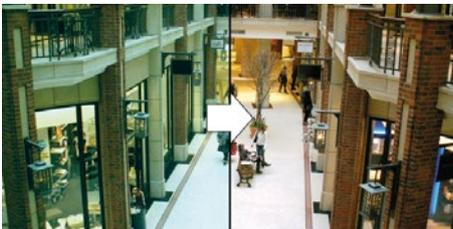
Bei Farbkameras wird die Farbe des beobachteten Objekts von der Farbtemperatur der Ausleuchtung (z.B. bei Leuchtstoffröhren) bestimmt. Ein automatischer Weißabgleich kann auf wechselnde Lichtverhältnisse (z.B. Wechsel zwischen Tageslicht und Kunstlicht) reagieren und die Farbe des Bildes entsprechend abgleichen.
